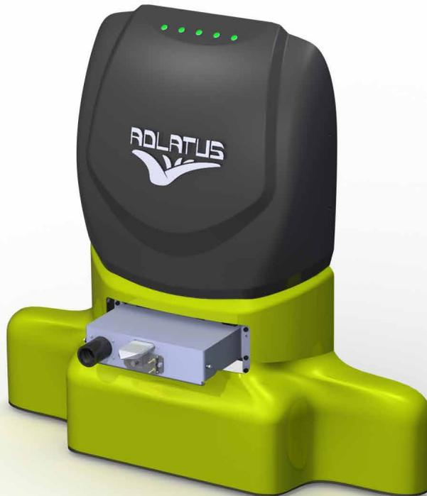
Die S700C Servicestation ermöglicht eine vollautomatische Ladung der Akkus, dem Ablassen des Schmutzwassers und Nachfüllen des Frischwassers und erhöht damit den Automatisierungsgrad des Reinigungsroboter-Systems. Mit einem hinterlegten Zeitplan erfolgt der Start der Reinigungsprogramme zeitgesteuert zu jedem Wochentag und Uhrzeit voll autonom.
